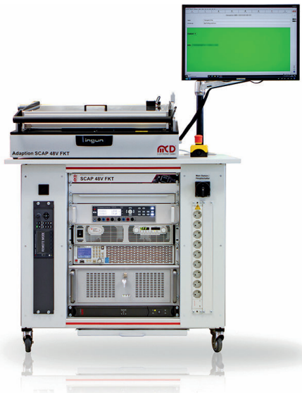
Bild 1. Das MCD Funktionstestsystem analysiert bestückte Platinen in Bezug auf Spannungen, Ströme und Lasten. © MCD Elektronik GmbH
