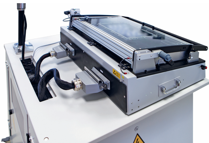
Bild 2. Die Prüflinge werden mit bis zu 200 Ampere stimuliert, was der Maximallast im späteren Fahrzeug entspricht. © MCD Elektronik GmbH
